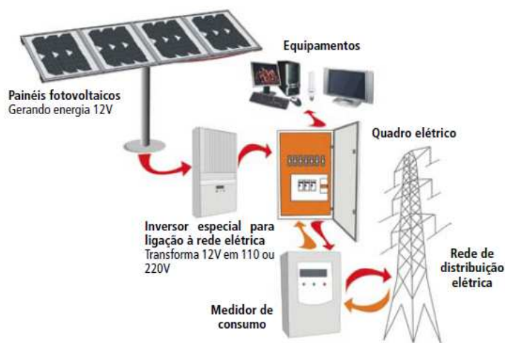
FIGURA 48 – Sistema de produção de energia interligado a rede Fonte: VIGGIANO (2010)
